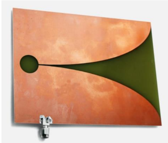
Fertige Platine mit SMA-Anschluss, Strip-Line auf der Rückseite
